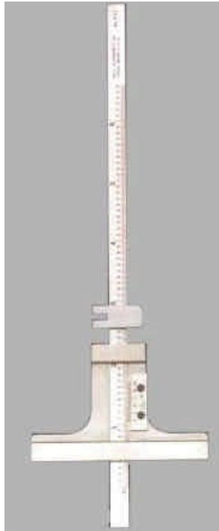
**Figura 7.4: Calibrador de profundidad.**
